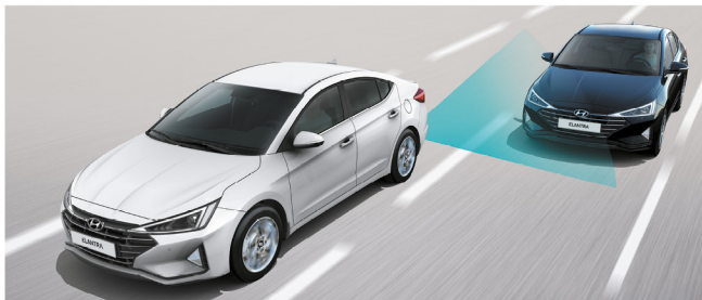
Система мониторинга «слепых» зон. Предупреждает водителя об автомобиле в слепой зоне.
