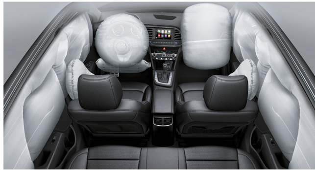
Система подушек безопасности / Дополнительная подушка безопасности для защиты ног водителя.
