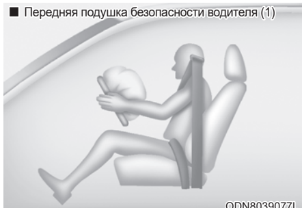
■ Передняя подушка безопасности водителя (1)
