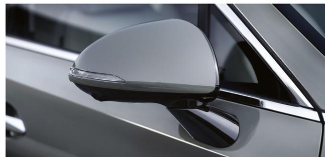
Электропривод складывания зеркал
