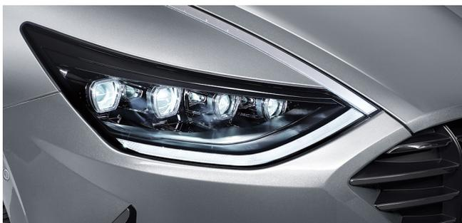
Светодиодные фары проекционного типа
